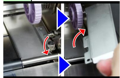
ラベルガイド(右)を固定しているネジを外し、ラベルガイド(右)を上を引き外します。
