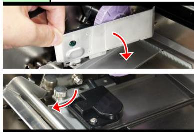
ラベルガイド(左)を下に差し込みセットし、ネジを締めます。
