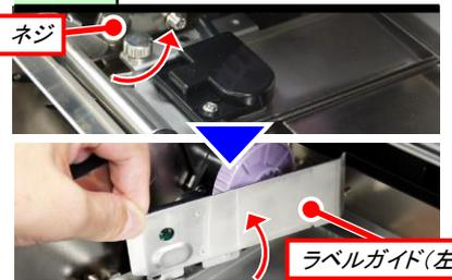
ラベルガイド(左)を固定しているネジを外し、ラベルガイド(左)を上へ引き外します。**センサーケーブルを断線させない様、注意して取り外してください!**
