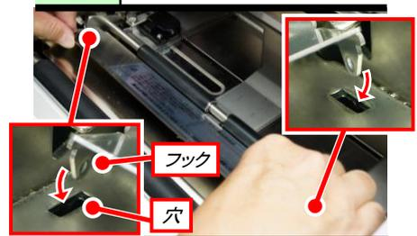
左右の用紙押えのフックを左右の四角い穴に押し込んでセットします。左右のフックが穴に入っていない状態で無理やり押さえ込むと用紙押えが変形してしまい、搬送不良等が発生するので気を付けてセットしてください。
