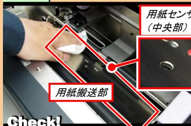
ウエスにプリンタ清掃液を染み込ませ、用紙搬送部を清掃して、用紙搬送部の中央部の用紙センサー-2の埃を、エアースプレーで吹き飛ばします。**ラベルが貼り付いている場合は取り除いてください。**
