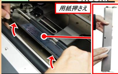
用紙押さえの両側を上方向に引いて外し、ウエスにプリンタ清掃液を染み込ませ、用紙押さえを清掃します。**ラベルが貼り付いている場合は取り除いてください。**
