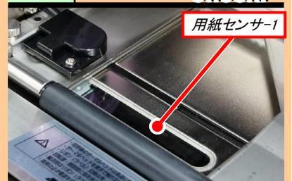
ウエスにプリンタ清掃液を染み込ませ、用紙センサー-1を清掃します。
