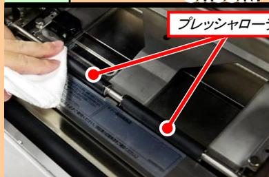
ウエスにプリンタ清掃液を染み込ませ、左右のプレッシュャローラを手で回しながら清掃します。
