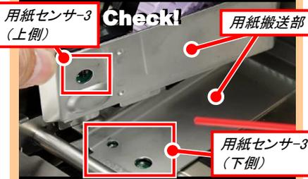
ウエスにプリンタ清掃液を染み込ませ、用紙搬送部を清掃して、用紙センサー-3(上側・下側)の埃を、エアースプレーで噴き飛ばします。ラベルが貼り付いている場合は取り除いてください。
