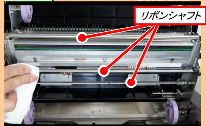
ウエスにプリンタ清掃液を染み込ませ、3箇所のリボンシャフトを清掃します。
