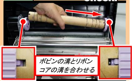
外したリボンコアをリボン巻取り部の右側のポビンに押し当てながらセットします。その際に、左右のポビンの溝に左右のリボンコアの溝を合わせます。
