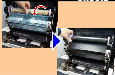
リボンをリボン供給部からサーマルヘッドの下に通して、リボン巻取り部のリボンコアに巻き付けます。次にリボン面にしわがない状態まで数回巻いてください。リボンルート図を参照
