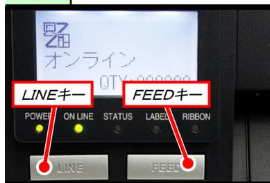
FEEDキーを押し、頭出しを行った後に、LINEキーを押しオンライン状態にします。
