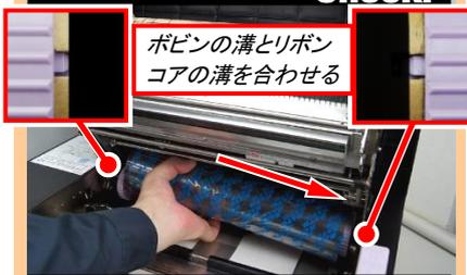
新しいリボンをリボン供給部の右側のポビンに押し当てながらセットします。その際に、左右のポビンの溝に左右のリボンコアの溝を合わせます。
