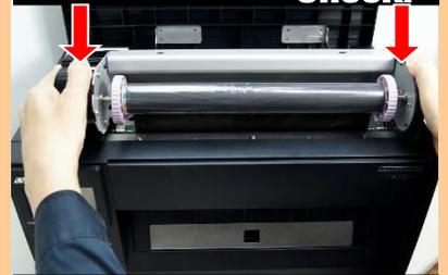
ラベルがセットされている事を確認して、左右の矢印にある部分を下に押し、サーマルヘッドを閉じます。
