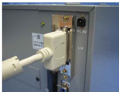
パラレルケーブル接続
