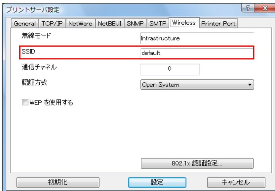
図 5-1-1. SSID 設定画面
