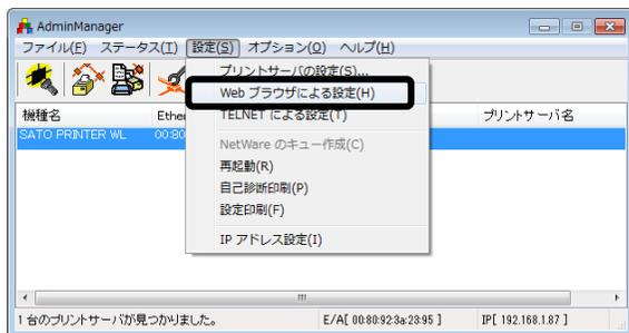
無線 LAN インタフェースボードの WEB 画面を表示します。「プリントサーバ機能」をクリックします。
