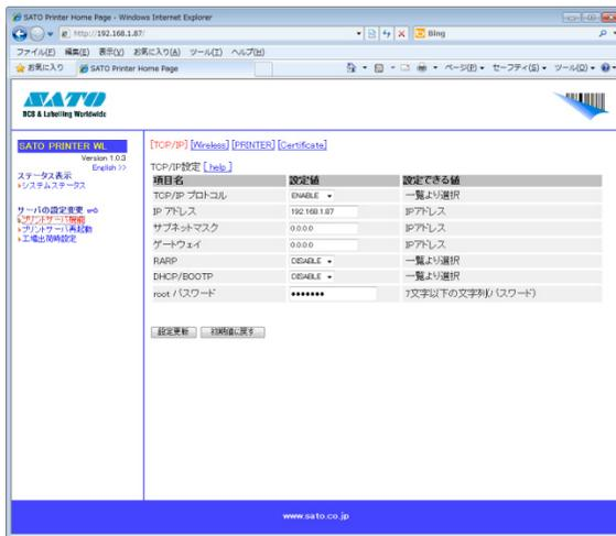
TCP/IP 設定画面では、「TCP/IP プロトコル」、「IP アドレス」、「サブネットマスク」、「ゲートウェイ」、「RARP」、「DHCP/BOOTP」、「root パスワード」の設定をおこなうことができます。
