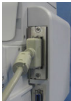
パラレルケーブル接続
