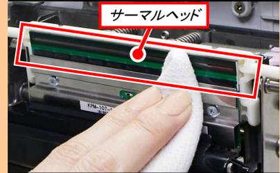
新しいウエスにプリンタ清掃液を染み込ませ、サーマルヘッドを清掃します。
