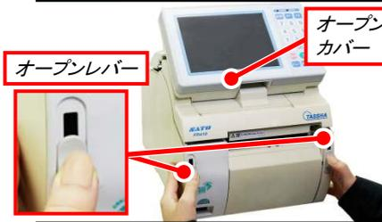
本体左右のオープンレバーを押し下げ、オープンカバーのロックを解除します。
