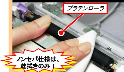
ウエスにプリンタ清掃液を染み込ませ、プラテンローラを手で回しながら清掃します。ノンセバ仕様(赤色のプラテンローラ)の場合は、プリンタ清掃液は使用しないで乾拭きで清掃してください。
