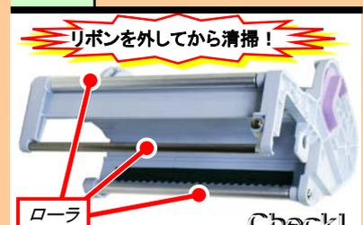
ウエスにプリンタ清掃液を染み込ませ、リボンカセットの3箇所のローラを手で回しながら清掃します。
