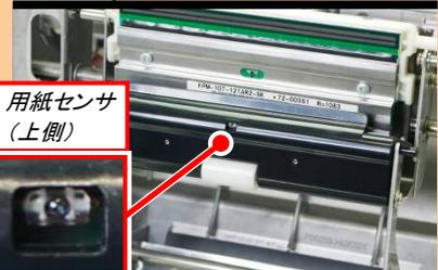
ウエスにプリンタ清掃液を染み込ませ、用紙センサ(上側)を清掃します。
