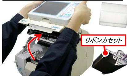
ディスプレイ上面及び、背面のグリップ部を両手で持ち、オープンカバーを開けます。ラベルとリボンカセット(オプション)がセットされている場合は、外してください。
