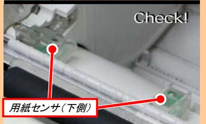
ウエスにプリンタ清掃液を染み込ませ、2箇所の用紙センサ(下側)を清掃します。
