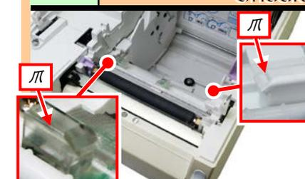
ウエスにプリンタ清掃液を染み込ませ、両側の用紙ガイドの爪を清掃します。
