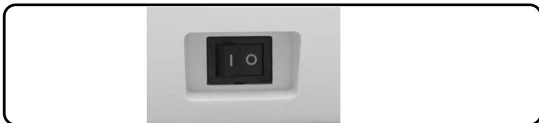
電源スイッチを入れるとPOWERランプが点灯し、タッチパネルにオープニング画面が表示されます。その画面にタッチすると通常モード画面に切り替ります。
