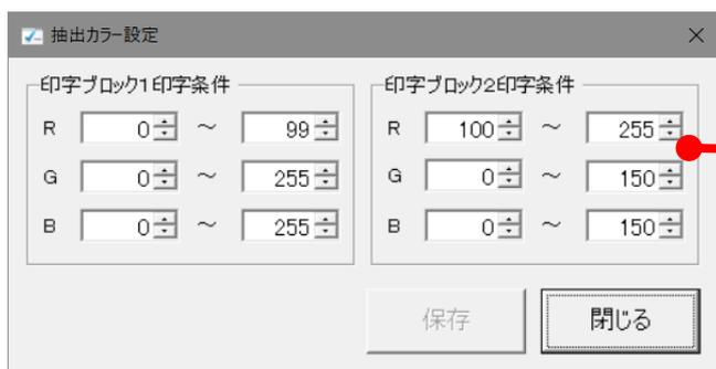
上記の設定では、RGB の R（赤）が 0~99 の場合は印字ブロック 1、R（赤）が 100~255 の場合は印字ブロック 2 に装着されたリボンで印字されます。
